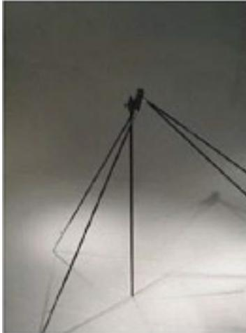
Spiegare le aste di fibra con la parte metallica più lunga e agganciarle al mozzo centrale. Inserire l'asta centrale retrattile nel mozzo. Posizionare le tre aste a terra.
