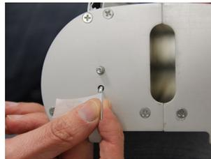
Rimuovere il perno per inserire la grafica nel telaio. Afferrare bene la grafica e il telaio affinché l'avvolgimento sia eseguito correttamente.
