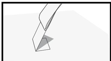
Avec un ruban adhésif type Tesa® 50110 ou équivalent, surface déposée 2,5 cm x 5 cm plus un débordement non collé pour permettre la prise en main. Plier et tirer d'un coup sec perpendiculairement à la surface du support. Le film doit opposer une résistance lors du retrait. Répéter l'opération à plusieurs endroits.
