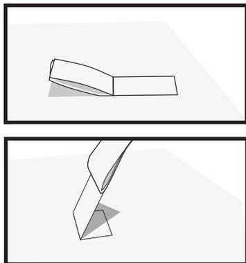
Avec un adhésif type Tesa® 50110 ou équivalent, surface déposée 2,5 cm x 5 cm plus un débordement non collé pour permettre la prise en main. Plier et tirer d'un coup sec perpendiculairement à la surface du support. Le film doit opposer une résistance lors du retrait. Répéter l'opération à plusieurs endroits.
