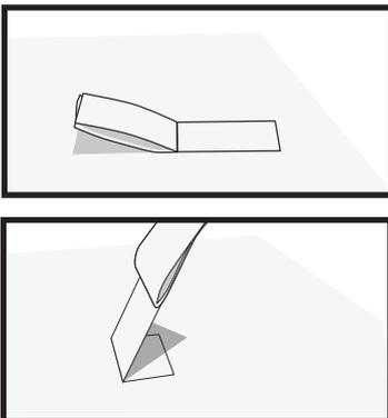
Mediante una cinta adhesiva Tesa® 50110 o equivalente, de 2,5 cm x 5 cm de superficie adherente, con una pestaña no adhesiva que permite su manipulación. Doble y tire de golpe perpendicularmente a la superficie del sustrato. El film debe ofrecer cierta resistencia al retirarlo. Repita la operación en varios lugares.
